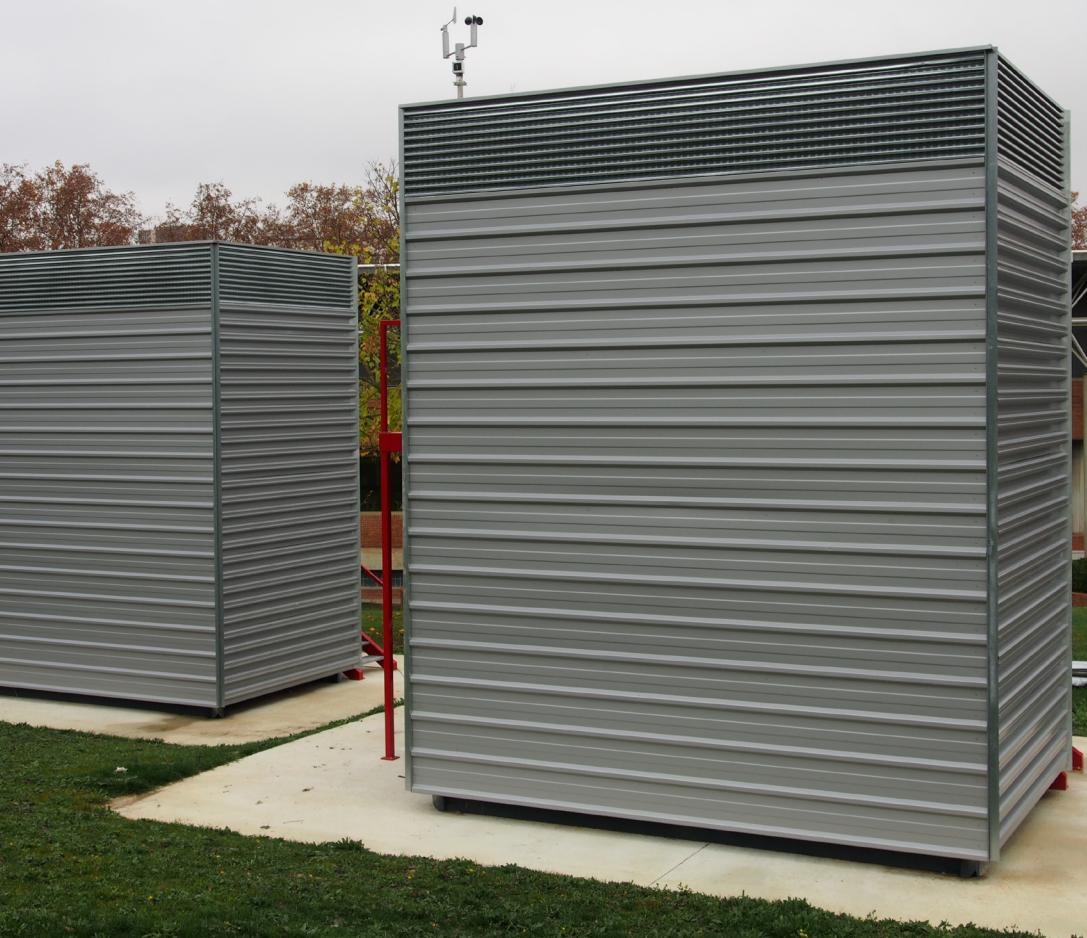
Prototipo de fachada termoeléctrica. Nótese las rejillas en la parte superior que permiten ventilar la hada, así como la estación meteorológica (Universidad de Navarra, 2017).
